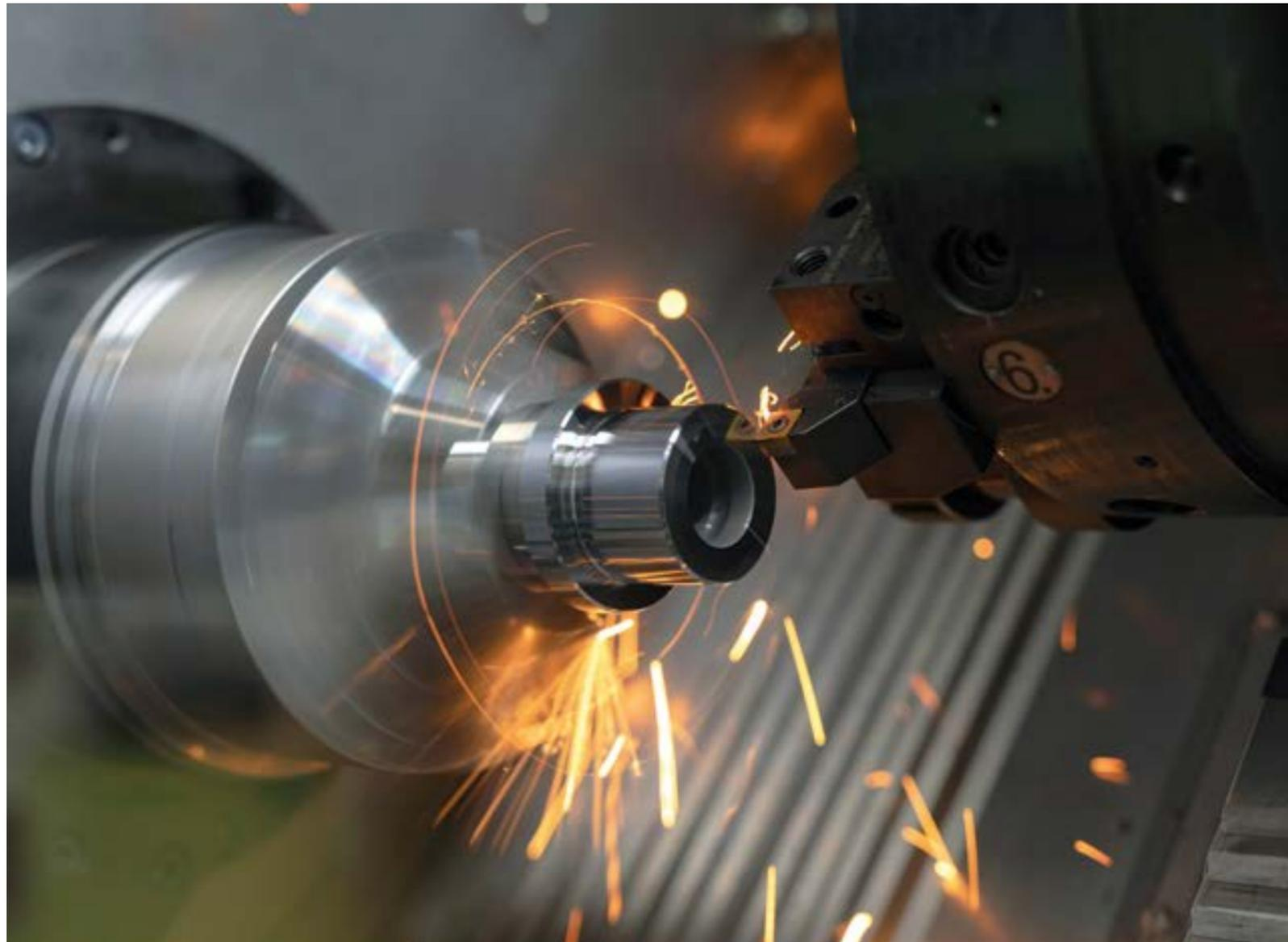
In diesem Katalog wird eine Baureihe von hochpräzisen, vollhydrostatischen Hartdrehmaschinen vorgestellt. Jede Maschine wurde mit einem Ziel vor Augen entwickelt: die Herstellung von gebrauchsfertigen, hochpräzisen Werkstücken direkt im gehärteten Zustand ohne jegliche Nachbearbeitung. Das ist was wir mit Finish-Hartdrehen meinen.
