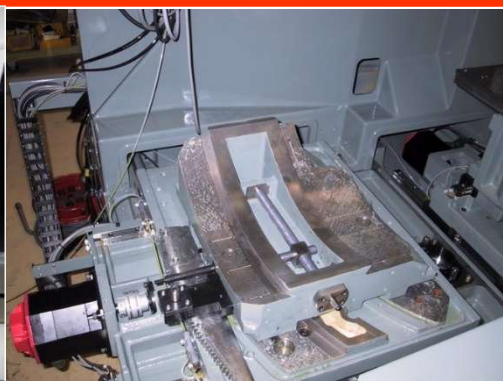
Maschine kpl. in Guss, Linearführungen, 50 nm Messsystem
