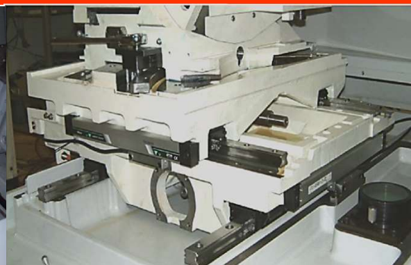
Maschine kpl. in Guss, Linearführungen, 50 nm Messsystem
