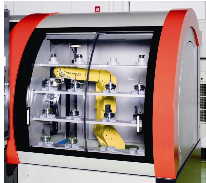
Roboter mit 8 Magazinplätze Schleifscheiben 8 Magazinplätze Paletten ITS
