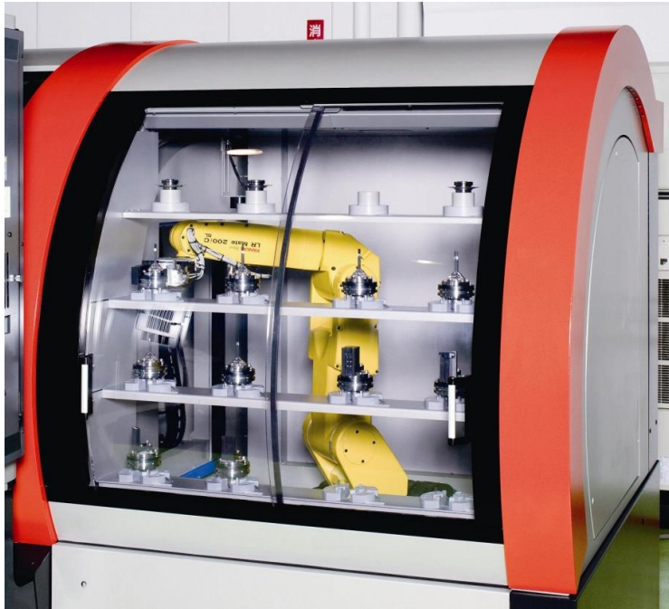
Roboter mit 8 Magazinplätze Schleifscheiben + 8 Magazinplätze Paletten
