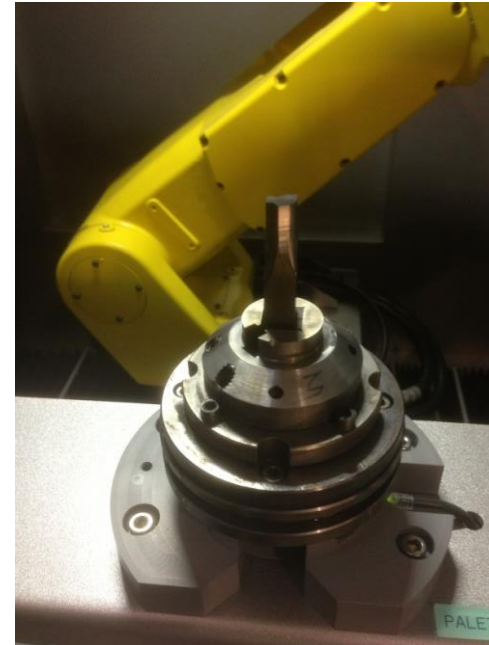
Einsetzen Palette mit ausgerichtetem Werkstückrohling auf Magazinplatz
