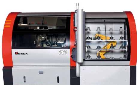
Rectifieuse de profils avec camera CCD et robotization des pieces et meules. DV1
