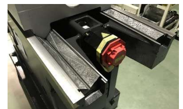
Glissières grattées à la main
