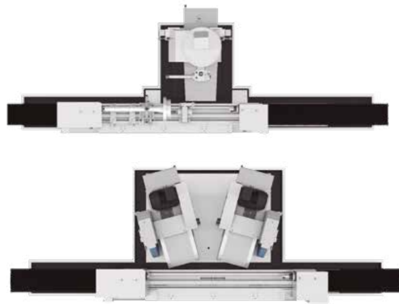
HG. Configuration de table mobile avec poupée porte-meule simple ou double pour la rectification séquentielle.
