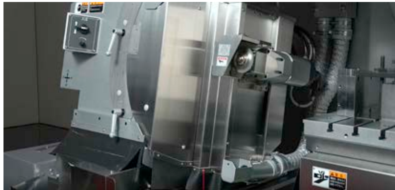
Schleifkopf mit bis zu 6 Achsen
